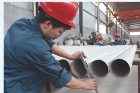
钢管尺寸检验 OD Checking
